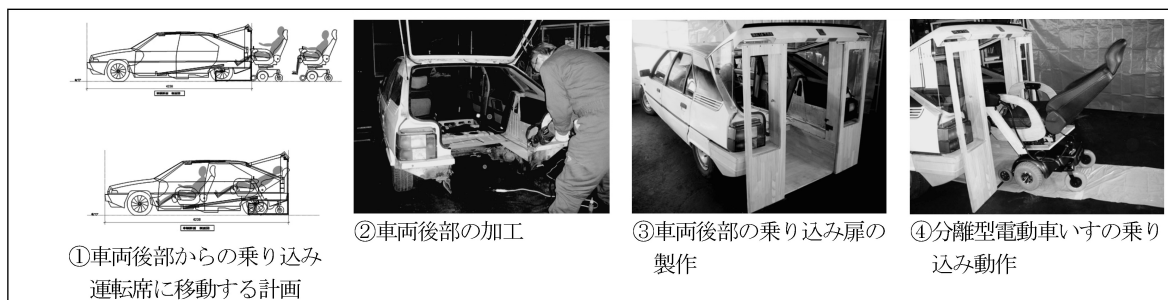
図4 車高調整型福祉車両の工夫
