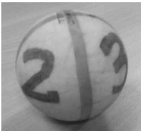
図5 ボール回転速度を求めるためのマーキング ボール(φ66 mm)表面に互いに直行する基準線を引いてマーキングした。
