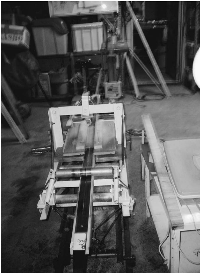
図2 スキー滑走面の鮫鱗皮グリップゾーンの擦動装置 奥にモータ。ゾーン（鉄枠下）面を加圧角材が擦動する。
