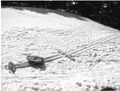
写真1 重量物荷重をした斜面滑降コースでの滑走性能試験
