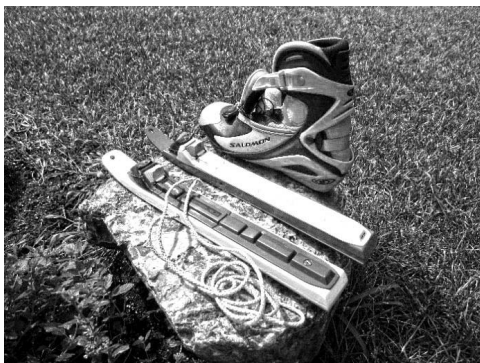
写真2 軽量・小型のスキー試験用に製作したミニチュアタイプのスキーセット
