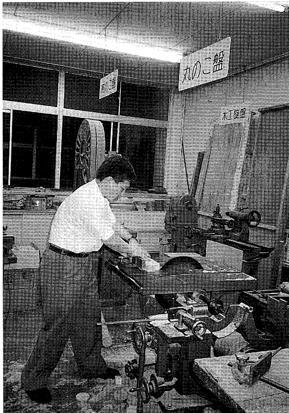
写真一 丸この盤を使用しての切断作業
