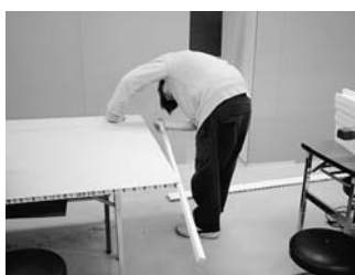
写真8 パネル輪郭の補強
