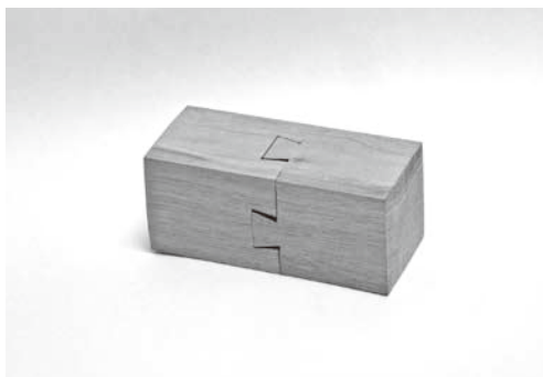
写真-8 四面の蟻継ぎ（水野制作）
