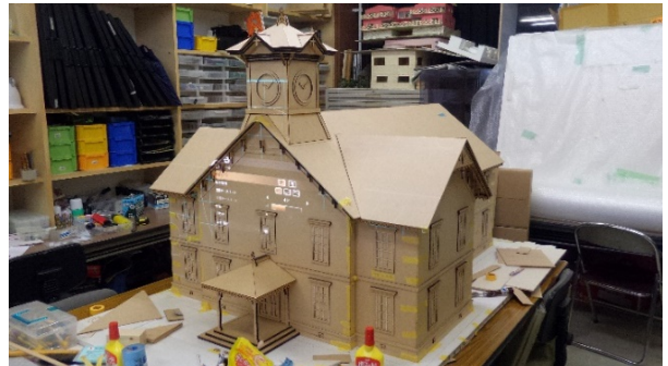
レーザーカッターでMDFを切断しパーツを製作、レーザーカッターで墨出した位置にパーツを接着し組み立てる
