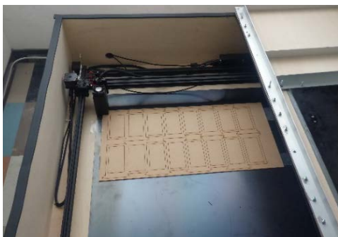
レーザーカッターでMDFを切断しパーツを製作、レーザーカッターで墨出した位置にパーツを接着し組み立てる
