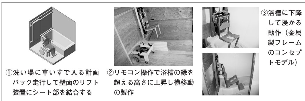
図2 浴槽移乗装置の開発プロセス
