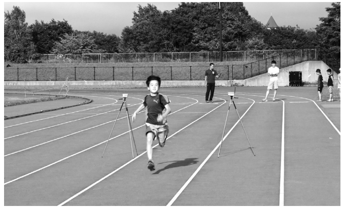
図8 光電管での50m走タイム測定
