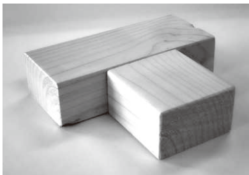
写真8 天狗ほぞを組み終えた全景
