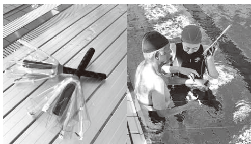
写真1 考案された開閉型無杖ハンドグリップツール（左）と実験風景（右）
