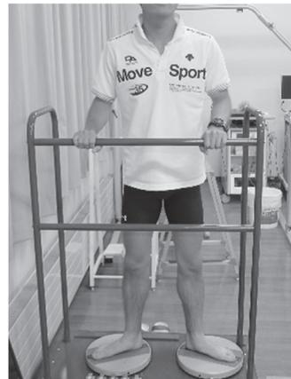
写真1 センター角の計測の様子。被験者は、2台の円形ターンテーブルの上にそれぞれの足を乗せて立位する。立位姿勢時の足幅(ターンテーブルの回転中心間距離)は42cmとした。両脚立位時の左右股関節の内旋角度可動域を計測し、その中間値をセンター角とした。
