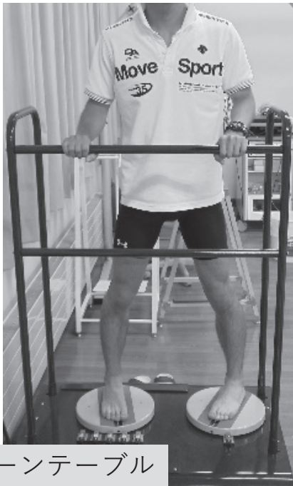
図1 スタンサーを用いたセンター角の計測の様子
