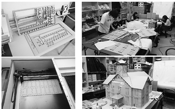
写真06. 時計台模型のパーツ加工と組み立て
