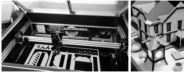
図7. レーザーカッターによる加工(左)と組み立て過程(右)
