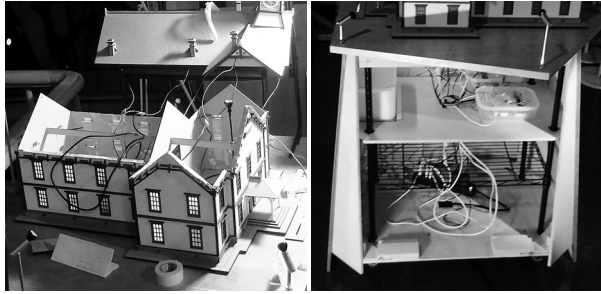
図17. ミニチュア時計台内部と設置第の内部配線
